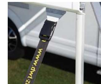
Zur Stabilisierung der Markise. Der Keder des Markisen-Sicherungs-Adapters wird in die Kederschiene des Markisen-Ausfallprofils eingeschoben. Der Sicherheitsgurt Plus ist Option.
